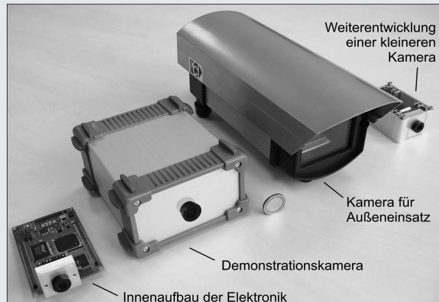
Abb. 5: Praktische Umsetzung der Dynamischen Video Anpassung in intelligenten Kameras
